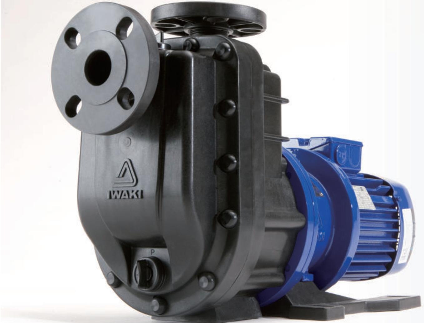
La SMX es una bomba de accionamiento magnético horizontal autocebante de plástico reforzado. Nuestra estructura original de autorradiación (patentada) mejora la resistencia al funcionamiento en seco, a la cavitación y a la operación de descarga cerrada. Además, el uso de motores estándar amplía el campo de aplicación.
